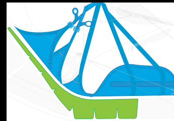
La protection NEO Koroyd 3.0 apporte la rigidité longitudinale du baquet pour garder son cap en vol accéléré.
